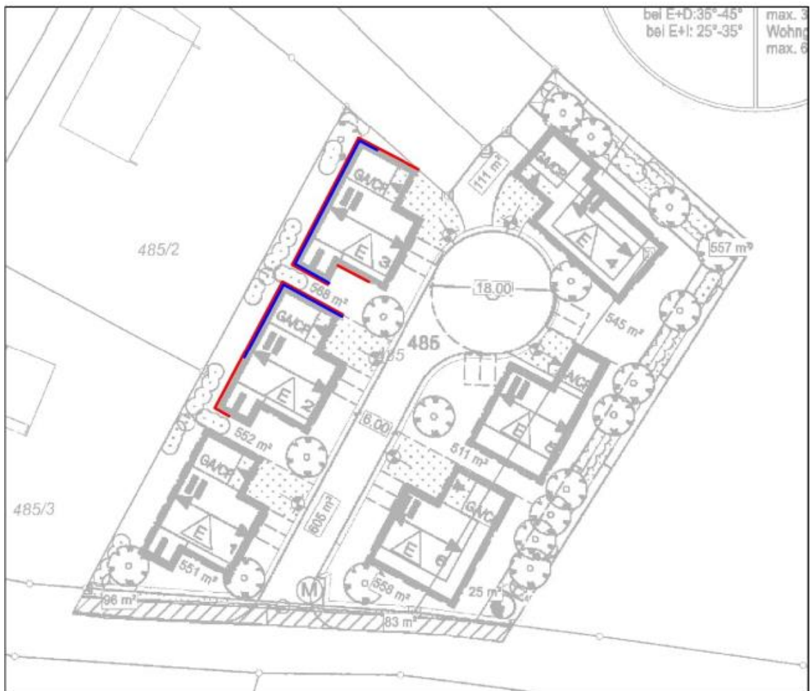
Lageplan mit Darstellung der Fassadenbereiche an denen Schallschutzmaßnahmen erforderlich sind
